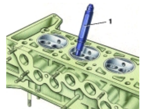
Рис. 2-99. Выпрессовка направляющих втулок: 1 – оправка
