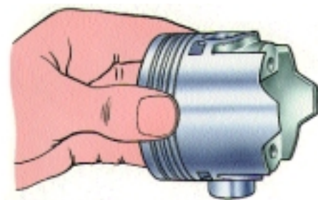
Рис. 2-76. Проверка посадки поршневого пальца двигателя мод. 2106-70
