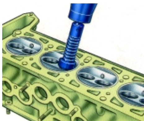
Рис. 2-97. Шлифовка рабочей фаски седла клапана
